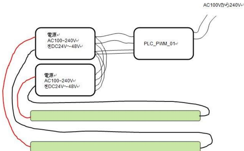
1 個の PLC\_PWM\_01 の PWM 信号で 3 個までの PWM 電源に並列接続できます。
