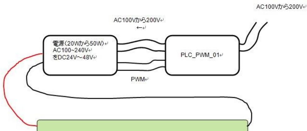
PLC\_PWM\_01 には、AC フィルター回路が内蔵されています。そのため、AC/DC 電源の AC 電源は PLC\_PWM\_01 のフィルターを通過したものを接続してください。フィルター回路の電流は、1A まで利用できます。
