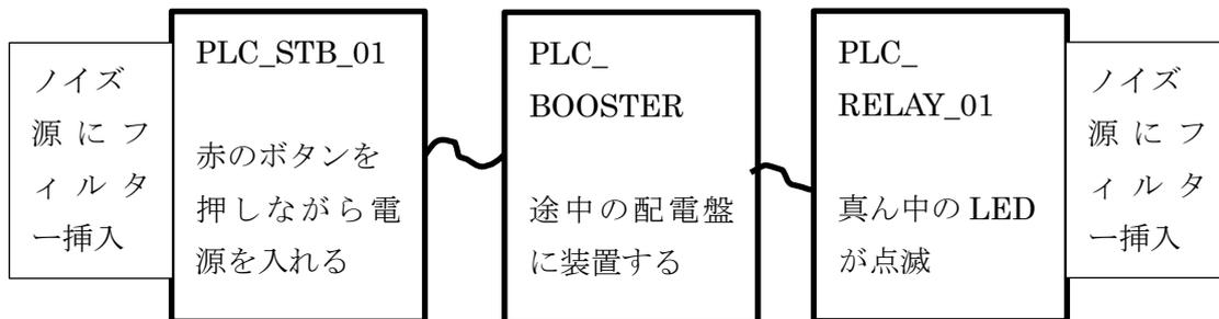
また、PLC\_SIGNAL\_01 (信号センサー) を使って、どの位置まで PLC\_STB\_01 からの信号が来ているのかを確認します。
