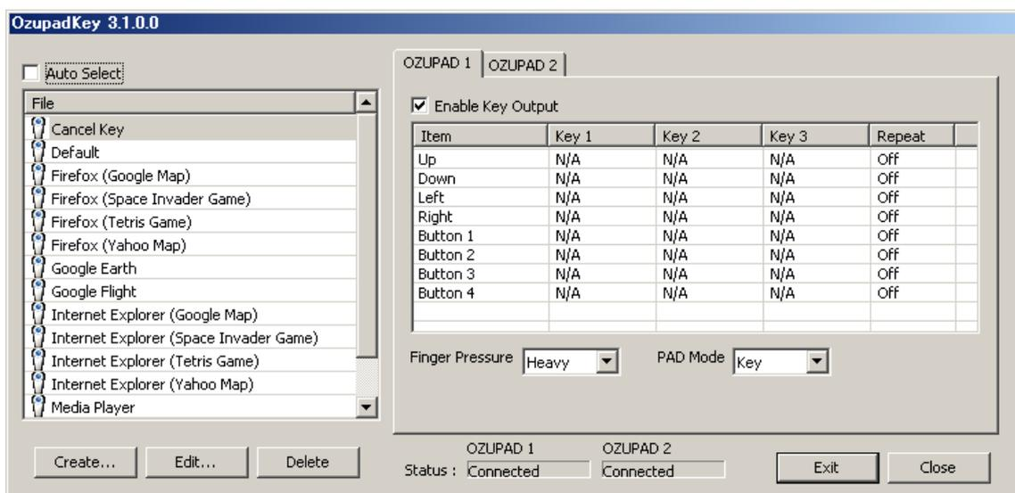
OZUPAD を USB ポートに差し込むと、Status の OZUPAD1が Connected になります。
